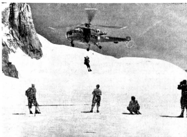
Wenn selbst ein Hubschrauber wegen der Schneetiefe im Hochgebirge nicht mehr landen kann, ist die „Alouette III“ immer noch in der Lage, die Helfer mit der Seilwinde abzusetzen und später wieder aufzunehmen.
