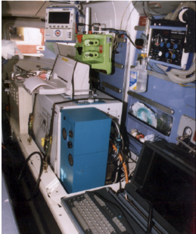
Abbildung 3.23: Verlastung des GC-MS-Systems mit einem Hubschrauber vom Typ BK 117
