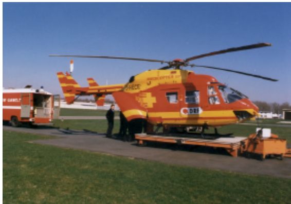
Abbildung 3.23: Verlastung des GC-MS-Systems mit einem Hubschrauber vom Typ BK 117
