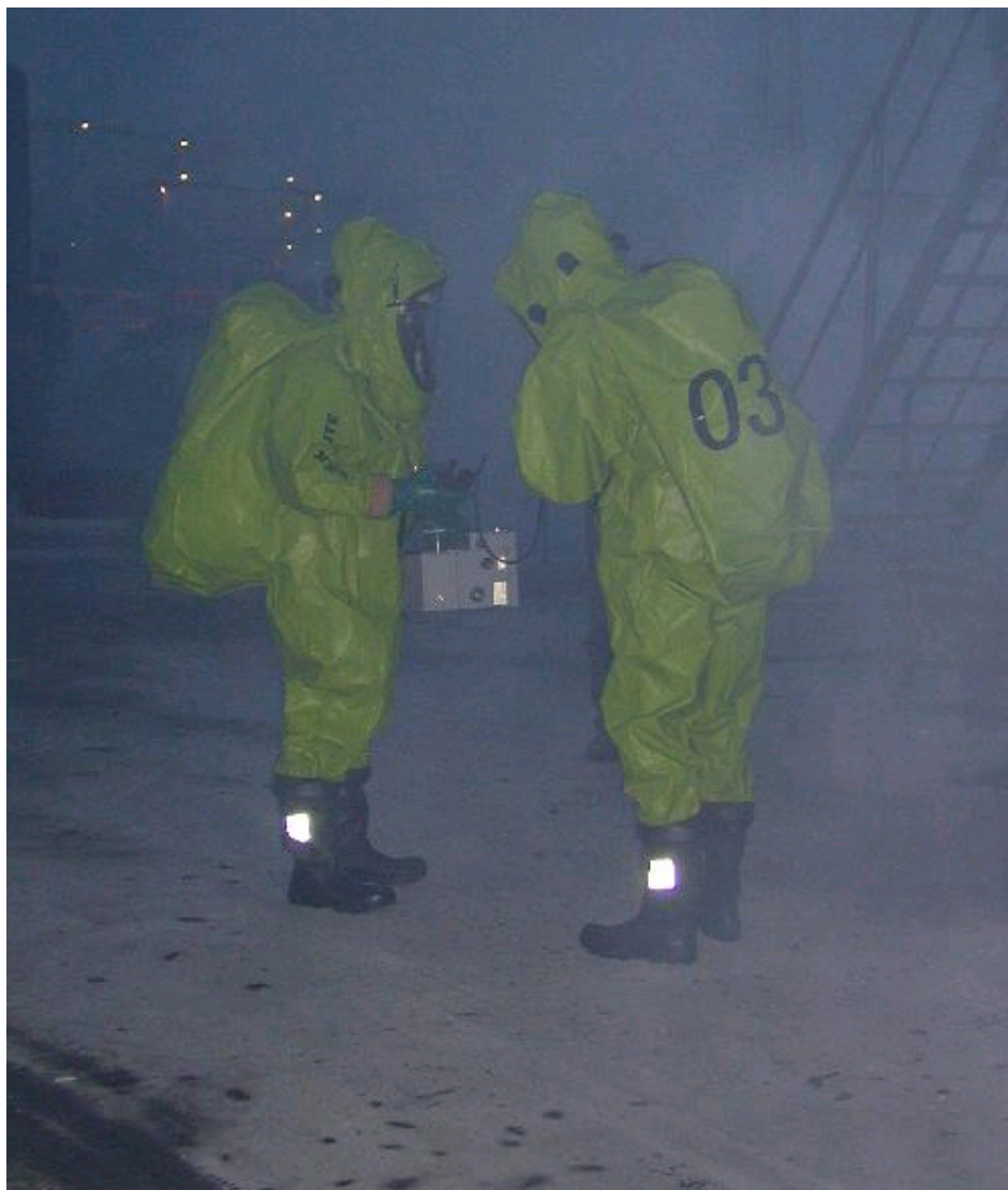
Abbildung 4.36: Spürtrupp mit GDA bei der Musterwertaufnahme und Probennahme
