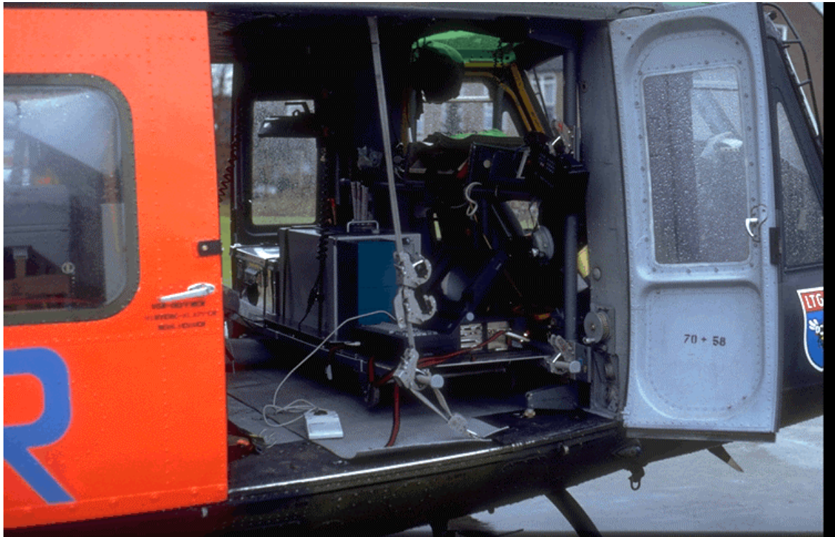
Abbildung 4.13: Verlastung des GC-MS-Systems mit einem Hubschrauber vom Typ Bell UH1D
