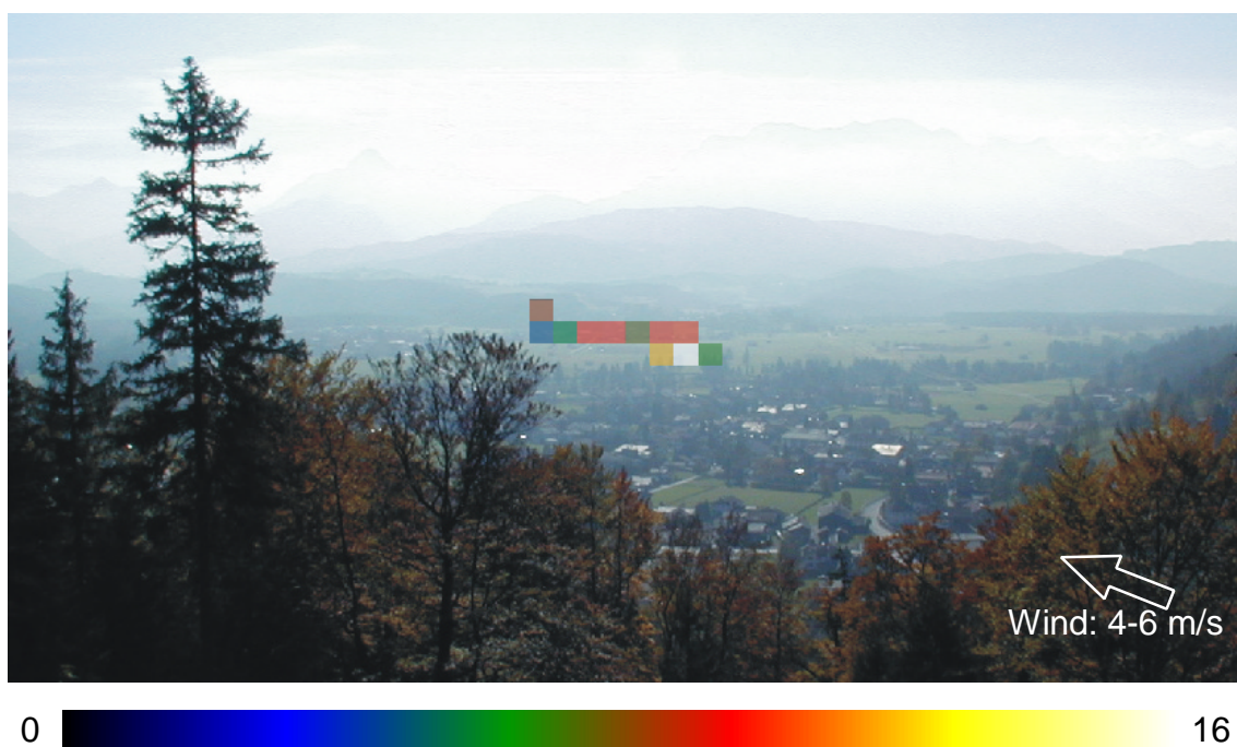
Abbildung 4.26: Bild der einer Schwefelhexafluorid-Wolke, gemessen aus einer Entfernung von ca. 2,5 km. In den Peilrichtungen, in denen Schwefelhexafluorid identifiziert wurde ist das Signal-Rausch-Verhältnis gemäss der abgebildeten Farbskala dargestellt.
